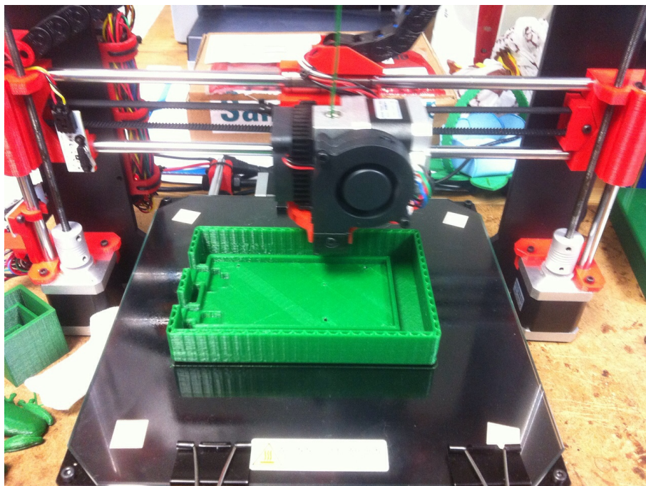
Figura 21.5.0.11 – Imagen de la base de la caja del localizador en proceso de fabricación
